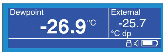
Figura 11 Visor típico do ponto de orvalho externo
