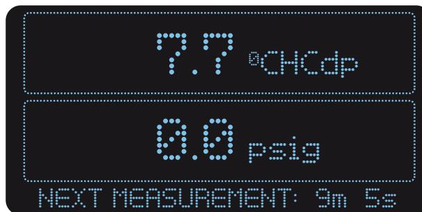
Figura 15 Página MAIN sem o sensor Wdp instalado
