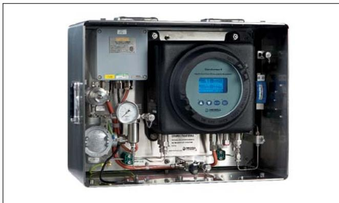
Um sistema de análise do ponto de orvalho de gás natural, transportável e completo, para medições por amostragem em campo. Funcionamento periódico online quando localizado num armário de analisador com temperatura uniforme. Acesso instantâneo às medições e à funcionalidade através de um visor alfanumérico integrado e interface HMI em vidro táctil, incluindo um registo das leituras de ponto de orvalho para verificação pelo operador.
